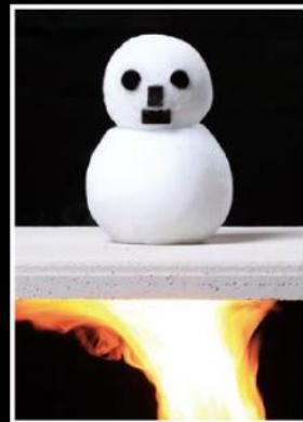
パワーボードの上に雪だるまを乗せてバーナーで加熱しても溶けずに残りました！
